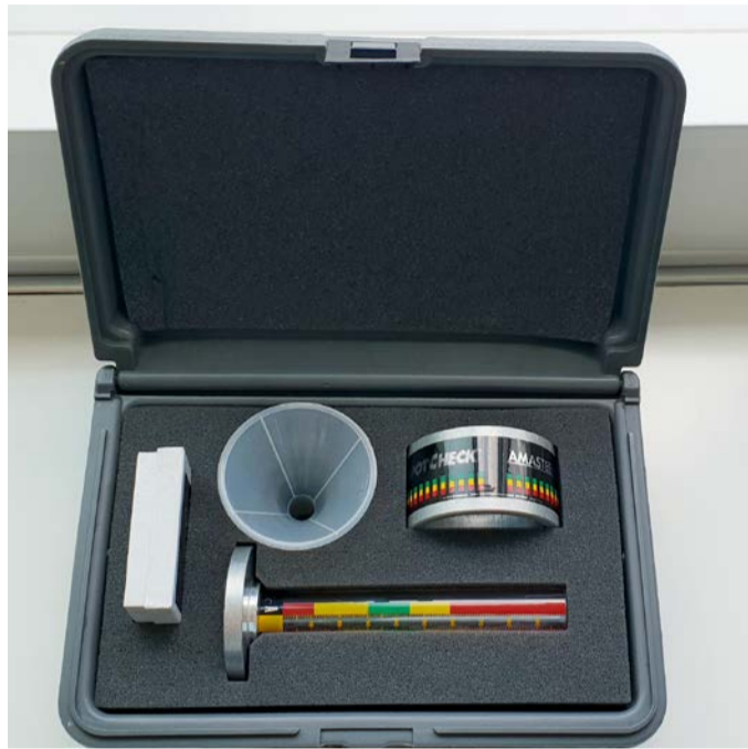
Mit dem „Ervin Spot Check Kit“ können Anwender das Strahlmittelbetriebsgemisch schnell und unkompliziert kontrollieren. Foto: Ervin
