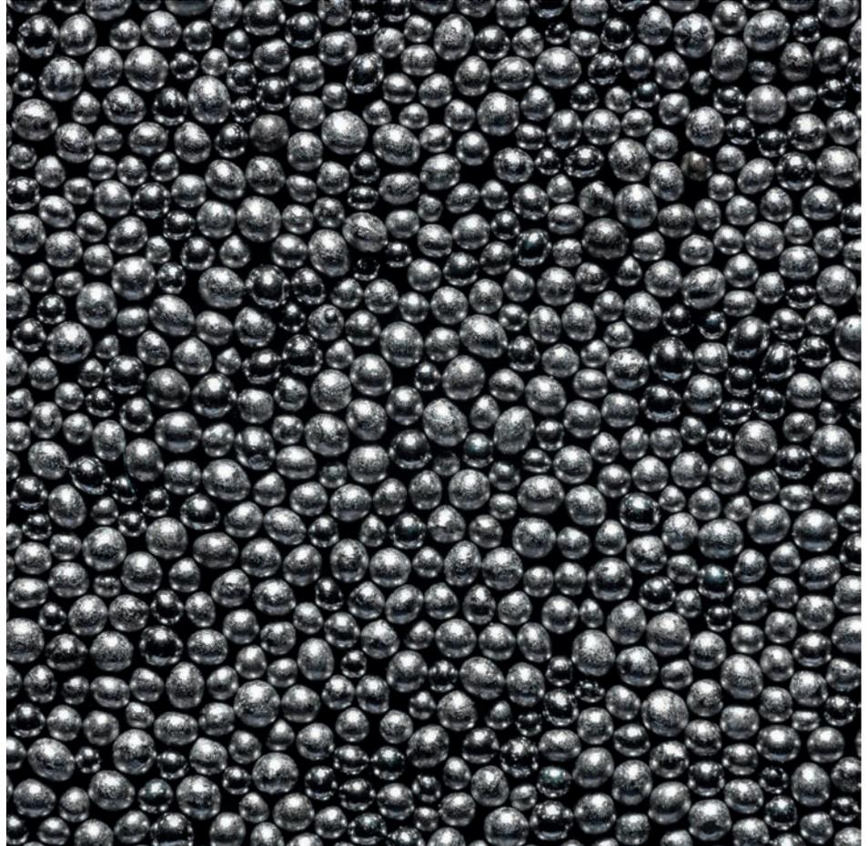
La tecnologia Ervin per gli abrasivi in acciaio inossidabile è la più avanzata al mondo. La graniglia AMACAST viene prodotta a Tecumseh (Stati Uniti) mediante un processo produttivo unico nel settore degli abrasivi, sviluppato per la difesa aerospaziale. Questa tecnologia esclusiva, grazie anche al know-how del team acciaio inox di Sprockhövel (Germania), ha permesso di realizzare una graniglia di acciaio inossidabile austenitica di altissima qualità.
