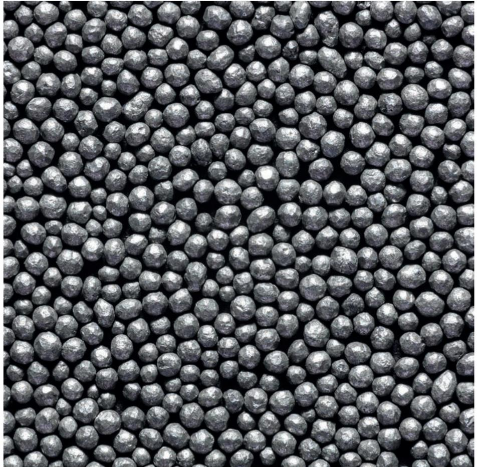
Unser Herstellungsprozess für Edelstahlstrahlmittel ist weltweit der fortschrittlichste. Die Produktion in Sprockhövel (Deutschland), verbunden mit dem Know-How des eigenen Technologiezentrums in Tecumseh (USA), machen AMACHROME zu einem der qualitativ hochwertigsten runden ferritischen Edelstahlstrahlmittel.
