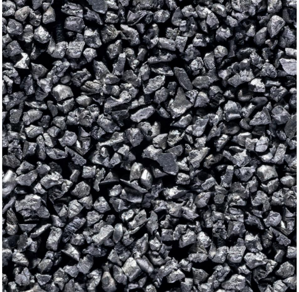
Unser Herstellungsprozess für Edelstahlstrahlmittel ist weltweit der fortschrittlichste. Die Produktion in Sprockhövel (Deutschland), verbunden mit dem Know-How des eigenen Technologiezentrums in Tecumseh (USA), machen AMAGRIT zu einem der qualitativ hochwertigsten kantigen Edelstahlstrahlmittel.
