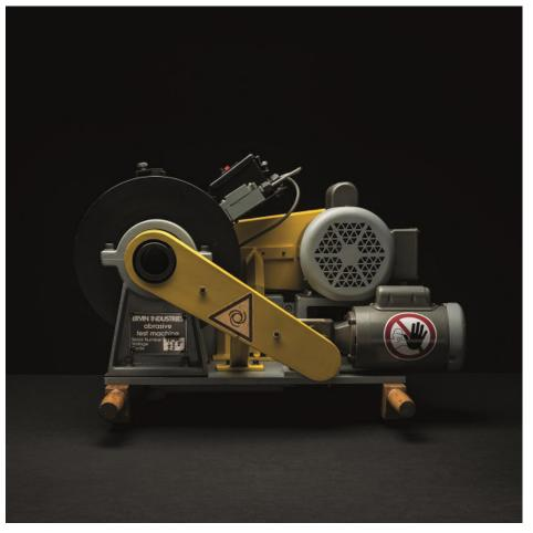
La máquina de prueba Ervin, encarnación del innovador espíritu pionero de nuestro fundador John F Ervin, se utiliza desde su patente en 1947 para medir la calidad abrasiva de los materiales. Mediante pruebas estandarizadas, esta máquina puede comparar la durabilidad y la energía transmitida por diferentes abrasivos.
