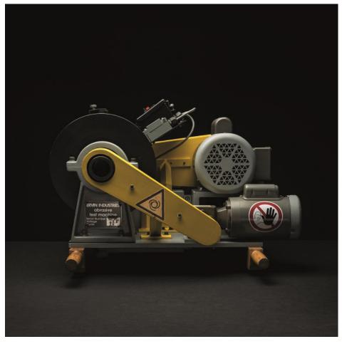
Da quando è stata brevettata nel 1947, la Macchina per Prove Ervin è stata ampiamente utilizzata per valutare la qualità degli abrasivi e incarna lo spirito innovativo e pionieristico del nostro fondatore John F. Ervin. Attraverso test standardizzati, è in grado di confrontare la durata di diversi abrasivi e l'energia che trasmettono.
