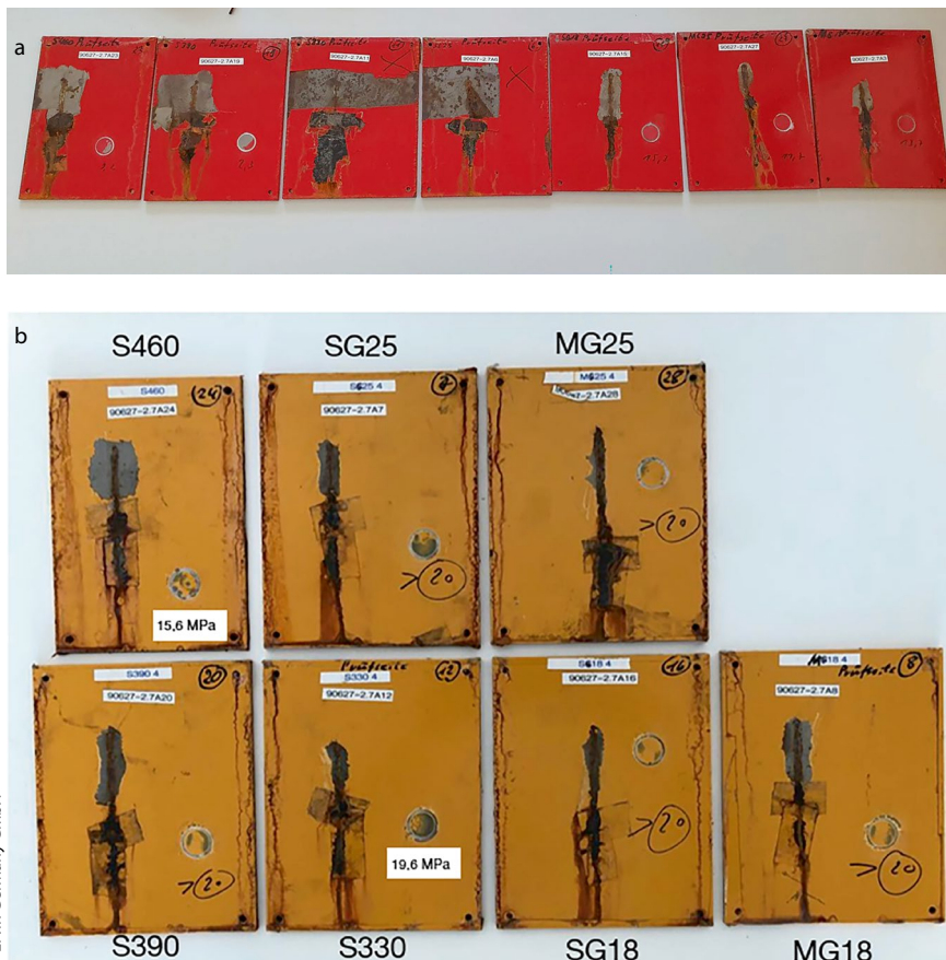
Bild 4 > Ergebnisse Salzsprühnebeltests nach 1000h sowie Stempelabriss (Pulverbeschichtung in Rot, Nasslack in Orange).
