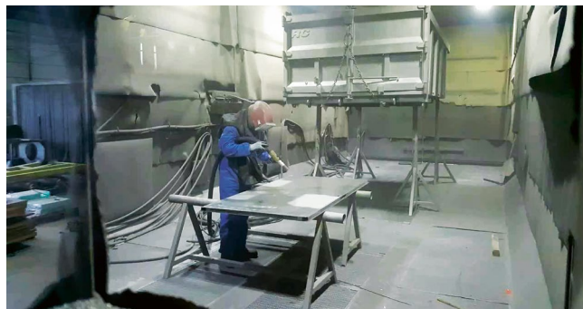
Bild 2 > Bei der Verwendung des Edelstahlstrahlmittels ist die Staubentwicklung deutlich geringer. So hat der Strahler freie Sicht.
