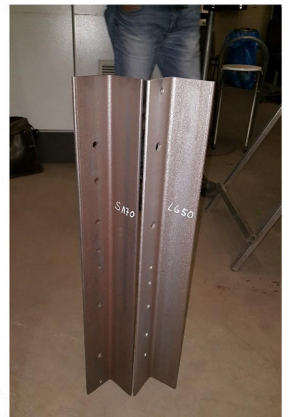
Amasteel LG50 Grit ile S170 düşük karbonlu shot arasındaki temizleme performansı farkı. Çelik parçalar aynı koşullarda birer dakika kumlannmıştır.
