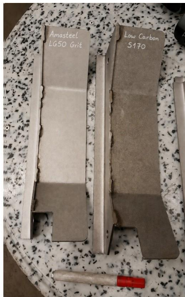
Amasteel LG50 Grit ile S170 düşük karbonlu shot arasındaki temizleme performansı farkı. Çelik parçalar aynı koşullarda birer dakika kumlannmıştır.
