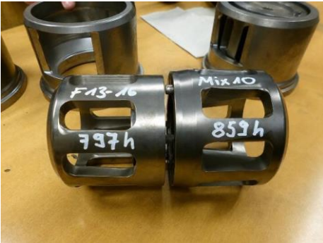
Dökümhane Amasteel Shot/Grit karışımı ile düşük karbonlu Shot arasındaki aşınan parça karşılaştırması
