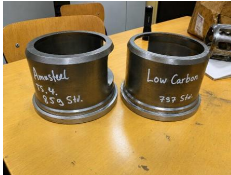
Dökümhane Amasteel Shot/Grit karışımı ile düşük karbonlu Shot arasındaki aşınan parça karşılaştırması
