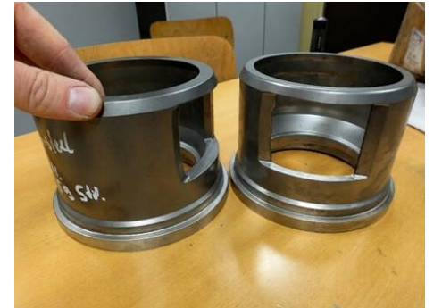
Dökümhane Amasteel Shot/Grit karışımı ile düşük karbonlu Shot arasındaki aşınan parça karşılaştırması
